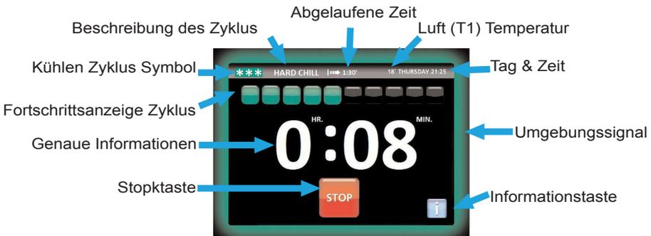
(Manche Symbole oder Tasten sind nur während der Einstellung sichtbar, wenn Sie von Parametern oder durch den Betrieb/manuelle Auswahl aktiviert werden).
